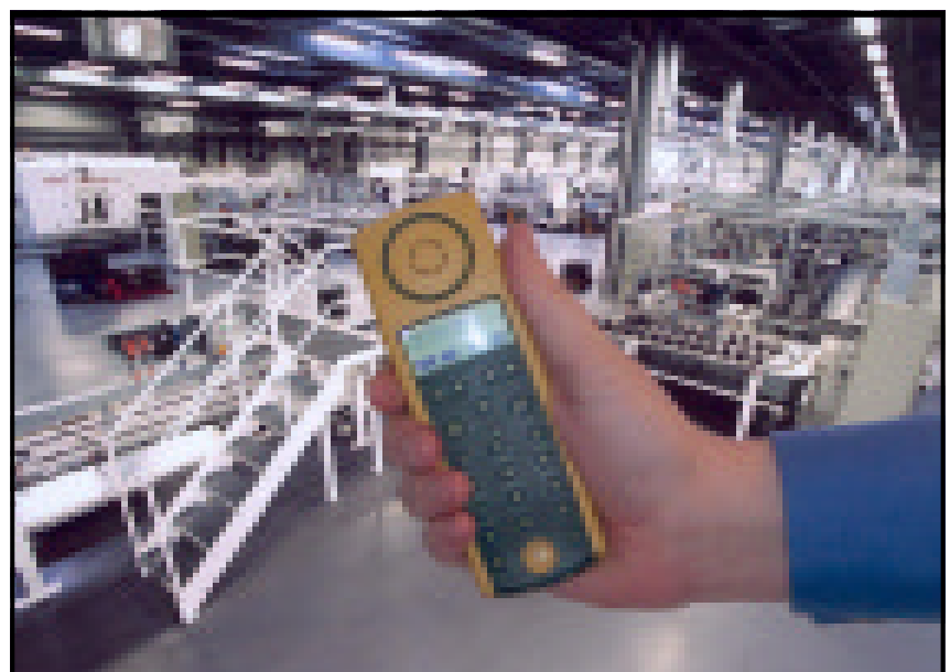
Met FunkServerPro van Siemens worden alarms en storingen aan machinelijnen onmiddellijk doorgegeven aan dienstdoende operators of monteurs.
